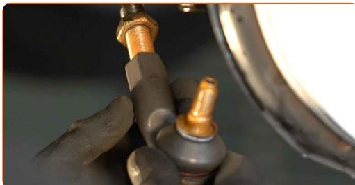
Výměna: kulového čepu řízení - VW Touran 1T1 1T2. Profesionálové doporučují:
