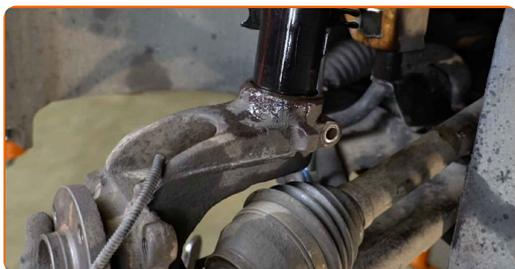
57 Podepřete kloub řízení. Použijte zvedák s hydraulickými převody.
