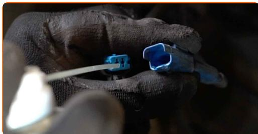
67 Připevněte konektor ABS snímače.
