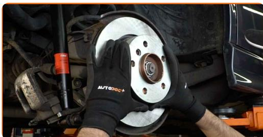
**23** Upevněte upevnění brzdového kotouče. Použijte imbusový klíč č. H6. Použijte momentový klíč. Utáhněte ji točivým momentem 9 Nm.
