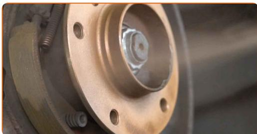
**22** Nainstalujte brzdový kotouč.
