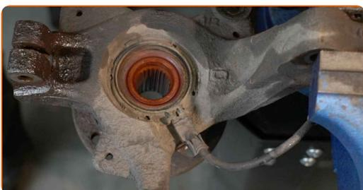
**36** Vyčistěte upevnění ABS snímače. Použijte drátěný kartáč. Použijte sprej WD-40.
