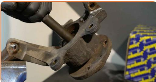
**39** Vytlačte vnitřní kolejničku ložiska z náboje kola. Použijte 3-ramenný stahovák ozubených koleček. Použijte separátor ložisek.
