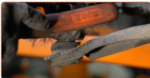
**22** Odšroubujte upevnění kulového čepu a táhla řízení. Použijte kombinační klíč č.16. Použijte nástavec č.16. Použijte vratidlo.
