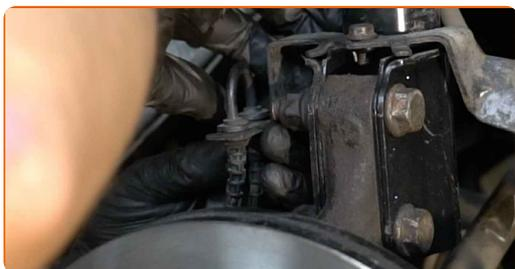
**73** Připevněte konektor ABS snímače.
