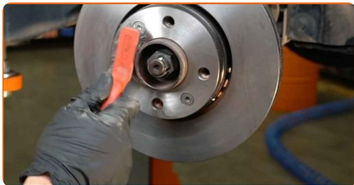
**16** Odšroubujte upevnění brzdového kotouče. Použijte hvězdicový Torx T 30. Použijte ráčnový klíč.
