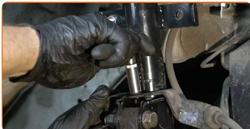
**72** Zapojte konektory ABS snímače.
