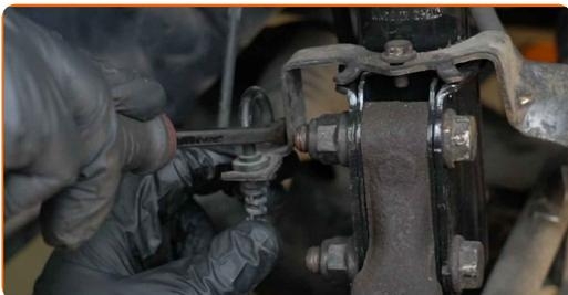
**9** Uvolněte upevňovací svorku brzdové hadičky od vzpěry tlumiče. Použijte nástavec č.10. Použijte ráčnový klíč.
