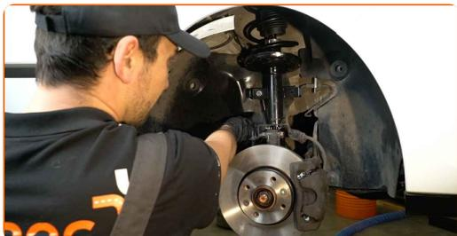
**75** Natřete upevňovací prvky tlumiče. Natřete upevňovací prvky kulového čepu. Natřete upevnění spojovací čep táhla řízení k hlavě ložiska čepu. Použijte měděné mazivo.
