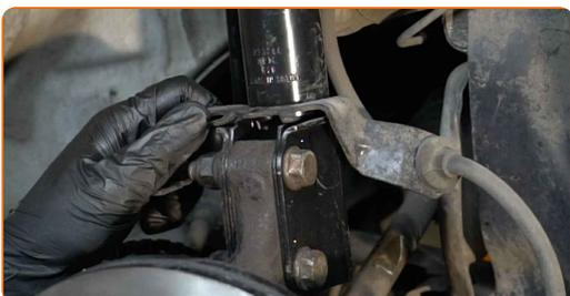
**71** Upevněte upevňovací svorku brzdové hadičky k vzpěře tlumiče. Použijte nástavec č.10. Použijte ráčnový klíč.
