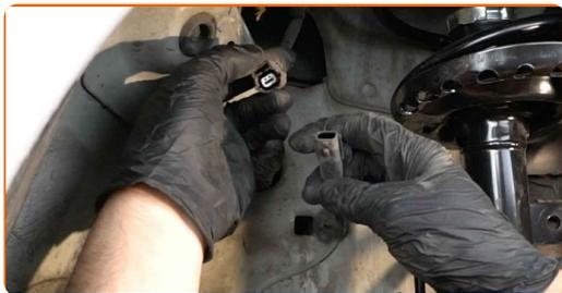
**21** Vyčistěte všechna spojení ramene. Použijte drátěný kartáč. Použijte sprej WD-40.
