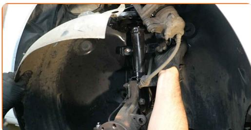
**19** Odpojte vodiče snímače ABS. Použijte nástroj na odstranění spony.
