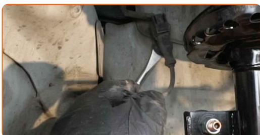
**20** Odpojte konektor ABS snímače.
