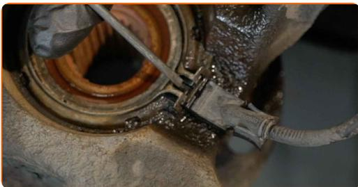
**38** Odstraňte náboj kola z kloubu řízení. Použijte průbojník. Použijte kladivo.
