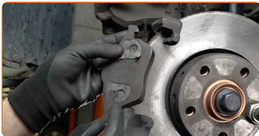
Výměna: brzdové destičky - Audi A6 C5 Avant. Doporučují odborníci z AUTODOC:
