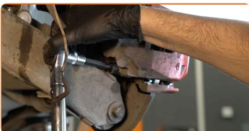
**27** Nainstalujte krytky prachového pouzdra vodičích závlaček brzdového třmenu.
