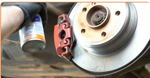
**31** Vyčistěte povrch brzdového kotouče. Použijte čistič brzd.
