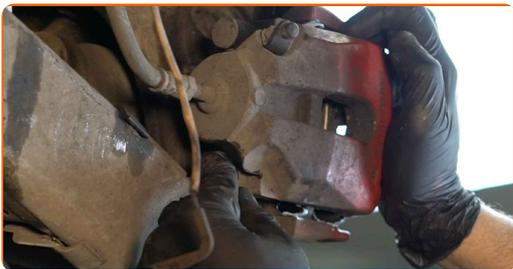
**28** Zapojte snímač opotřebení brzdových destiček.
