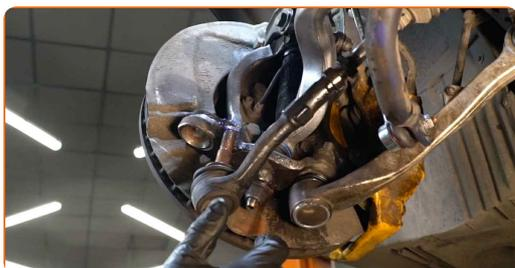
**31** Odstraňte zadní upevňovací prvek ovládacího ramene.
