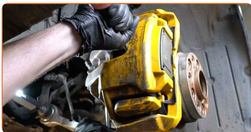
**7** Odšroubujte upevnění svorky brzdového třmenu. Použijte nástavec č.18. Použijte vratidlo.
