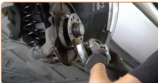
**19** Nainstalujte brzdový kotouč.
