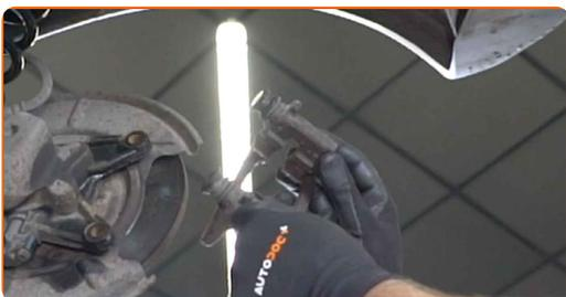
**15** Vyčistěte upevnění brzdového kotouče. Použijte drátěný kartáč. Použijte sprej WD-40.
