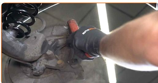
**13** Odšroubujte upevnění svorky brzdového třmenu. Použijte nástavec č.16. Použijte vratidlo. Použijte ráčnový klíč.
