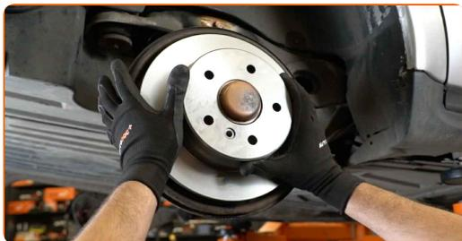
**20** Upevněte upevnění brzdového kotouče. Použijte hvězdicový Torx T 30. Použijte momentový klíč. Utáhněte ji točivým momentem 9 Nm.
