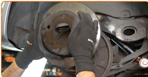
**18** Vyčistěte náboj. Použijte drátěný kartáč. Natřete kontaktní povrch. Použijte měděné mazivo.
