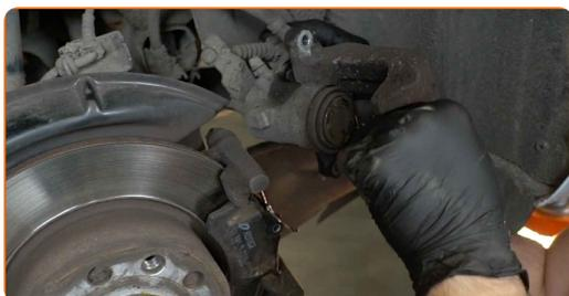
Výměna: brzdové destičky - Audi A3 8PA. AUTODOC doporučuje:
