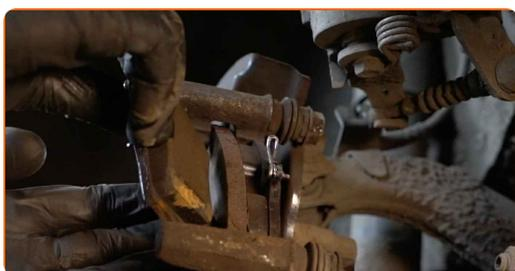
Výměna: brzdové destičky - Audi A3 8PA. Tip od AUTODOC:
