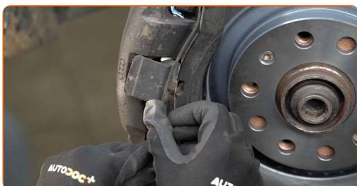
**23** Zapojte snímač opotřebení brzdových destiček.
