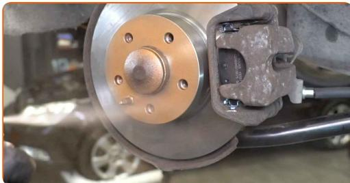
**21** Vyčistěte povrch brzdového kotouče. Použijte čistič brzd.
