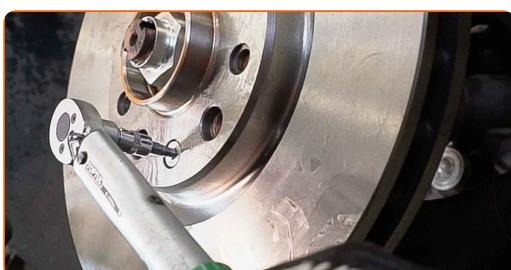
Výměna: brzdového kotouče - ALFA ROMEO GIULIETTA (940). Doporučují odborníci z AUTODOC:
