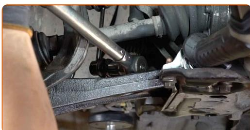
**14** Utáhněte upevňovací prvek spojující stabilizátor s vidlicí tlumiče odpružení. Použijte kombinační klíč č.17. Použijte nástavec č.17. Použijte imbusový klíč č. H5. Použijte momentový klíč. Utáhněte ji točivým momentem 55 Nm.
