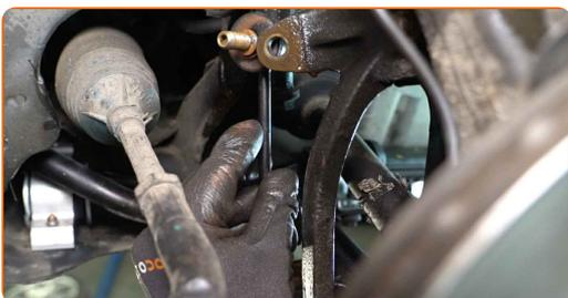
**12** Utáhněte upevňovací prvek vzpěry stabilizátoru. Použijte kombinační klíč č.17. Použijte imbusový klíč č. H5.
