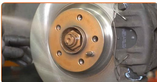
**18** Vyčistěte povrch brzdového kotouče. Použijte čistič brzd.
