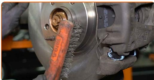
**17** Natřete povrch, kde je brzdový kotouč v kontaktu s ráfem kola. Použijte měděné mazivo.
