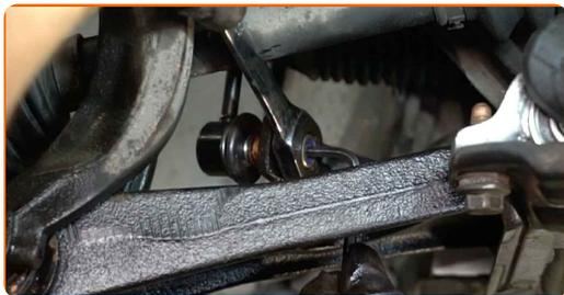
**13** Utáhněte upevnění spojující vzpěru stabilizátoru a stabilizátor. Použijte kombinační klíč č.17. Použijte nástavec č.17. Použijte imbusový klíč č. H5. Použijte momentový klíč. Utáhněte ji točivým momentem 55 Nm.
