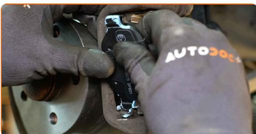
Výměna: brzdové destičky - ALFA ROMEO GT (937). Tip:
