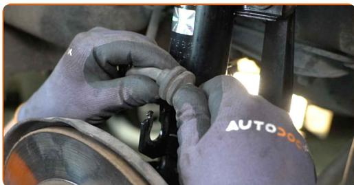
**8** Vyčistěte upevňovací prvky brzdového třmenu. Použijte drátěný kartáč. Použijte sprej WD-40.
