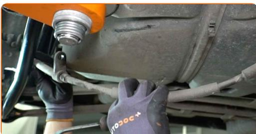
**10** Odšroubujte upevnění lanka parkovací brzdy. Použijte kombinační klíč č.10.
