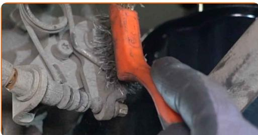
**6** Odpojte lanko parkovací brzdy od brzdového třmenu. Použijte páčidlo. Použijte kleště na vodní pumpu.
