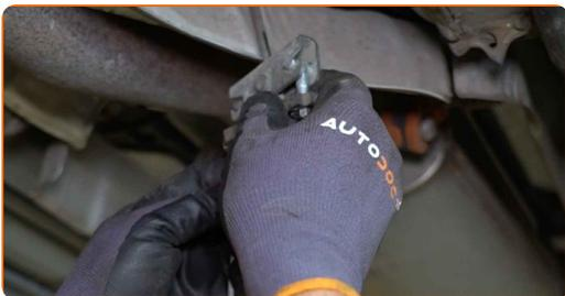
**18** Vyčistěte montážní pozice lanka parkovací brzdy. Použijte drátěný kartáč. Použijte sprej WD-40.
