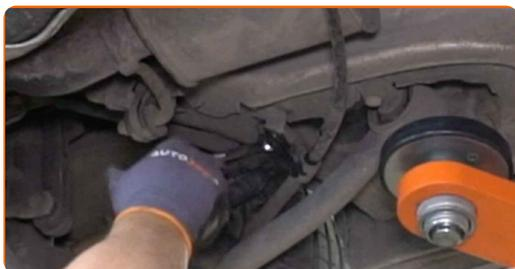
**11** Odpojte lanko parkovací brzdy od karoserie auta. Použijte páčidlo.
