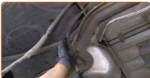
**12** Vyčistěte upevňovací prvek lanka parkovací brzdy. Použijte drátěný kartáč. Použijte sprej WD-40.
