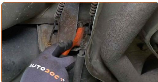
**13** Odstraňte zádržný držák lanka parkovací brzdy. Použijte páčidlo. Použijte kladivo.
