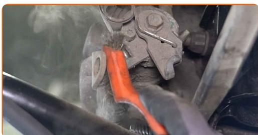
**24** Nainstalujte lanko parkovací brzdy na držák brzdového třmenu. Použijte páčidlo. Použijte kleště na vodní pumpu.
