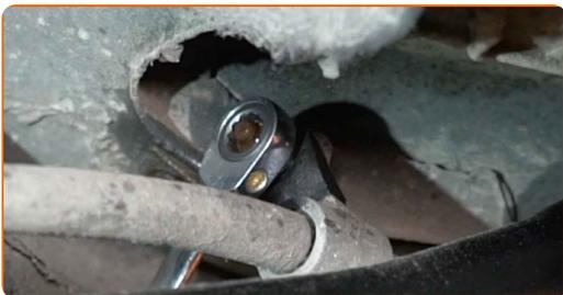
**9** Odpojte lanko parkovací brzdy od karoserie auta. Použijte páčidlo.
