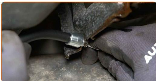
**20** Zajistěte lanko parkovací brzdy pomocí zádržného kroužku. Použijte kleště na vodní pumpu.
