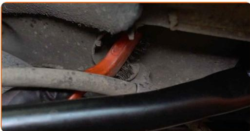
**8** Odšroubujte upevnění lanka parkovací brzdy. Použijte kombinační klíč č.10.
