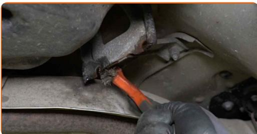
**19** Připojte lanko parkovací brzdy k mechanismu parkovací brzdy.
