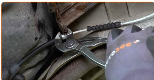
**21** Připevněte lanko parkovací brzdy ke karoserii auta.
