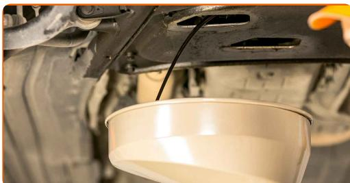
Výměna: motorového oleje a filtru - ALPINA B10 (E34). Tip od odborníků z AUTODOC:
