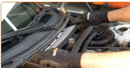
Výměna: kabinového filtru - ALPINA B3 kupé (E46). Doporučují odborníci z AUTODOC:
