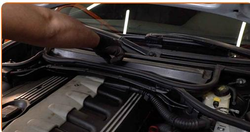
**4** Odstraňte kryt uložení kabinového filtru.
