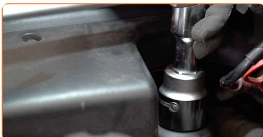
**30** Odstraňte uzávěr olejového systému. Vložte trychtýř.
