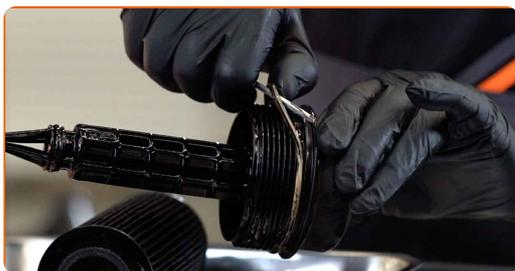
**16** Vyčistěte uzávěr krytu olejového filtru. Použijte víceúčelový čisticí sprej.
