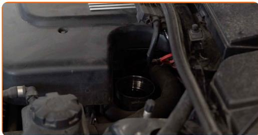
**27** Namažte gumové těsnění nového filtru malým množstvím čerstvého oleje.
