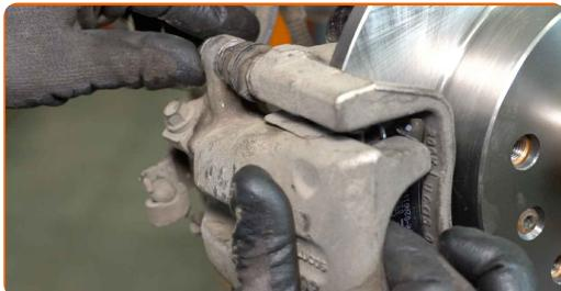
**19** Utáhněte upevnění brzdové hadičky. Použijte nástavec č.E11. Použijte momentový klíč. Utáhněte ji točivým momentem 15 Nm.
