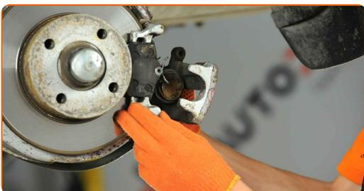
**Výměna: brzdového kotouče - AUDI 100 C2 Avant (43). AUTODOC doporučuje:**
