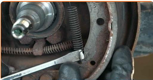
**17** Odpojte lanko ruční brzdy. Použijte páčidlo.
