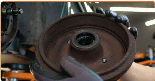
Výměna: brzdové čelisti - AUDI 80 B3 (89, 89Q, 8A). Profesionálové doporučují:
