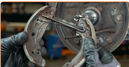
Výměna: brzdové čelisti - AUDI 80 B3 (89, 89Q, 8A). Tip od odborníků z AUTODOC:
