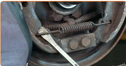
**15** Odstraňte držáky čelistí bubnové brzdy. Použijte nástroj na montáž pružiny brzdové čelisti.
