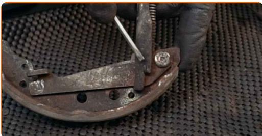
**20** Odstraňte páku seřizovače brzdové čelisti.
