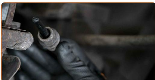
**20** Vyčistěte zbytky starého maziva a stopy rzi, pokud zde jsou, z vodících závlaček třmenu a z pouzder vodících závlaček. Použijte čistič brzd.
