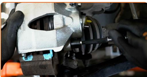
**Výměna: brzdového třmenu - AUDI A1 Hatchback (8X1, 8XK). Tip od AUTODOC:**
