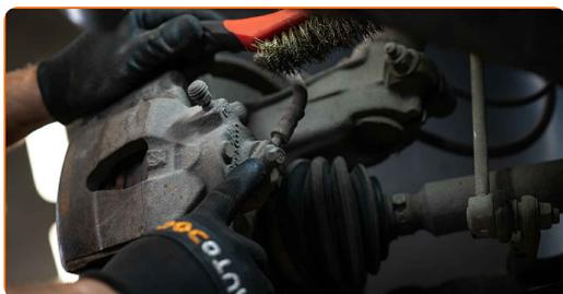
**Výměna: brzdového třmenu - AUDI A1 Hatchback (8X1, 8XK). Tip:**
