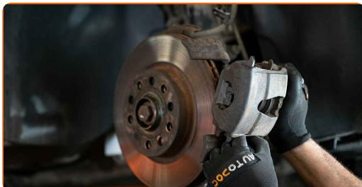
Výměna: brzdového třmenu - AUDI A2 (8Z0). AUTODOC doporučuje:
