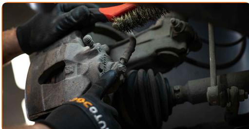
Výměna: brzdového třmenu - AUDI A2 (8Z0). Tip:
