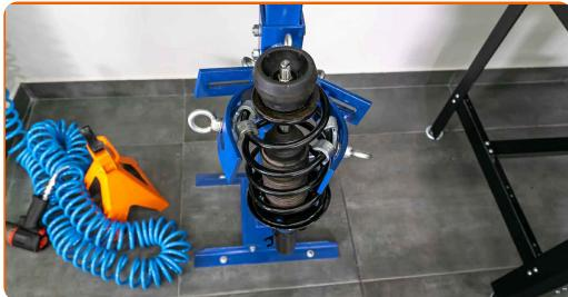
Výměna: uložení tlumiče - AUDI A3 Hatchback (8P1). Doporučují odborníci z AUTODOC:
