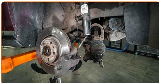
Výměna: uložení tlumiče - AUDI A3 Hatchback (8P1). Tip:
