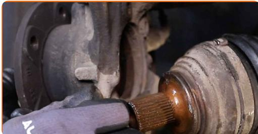
Výměna: ložiska kola - AUDI A3 Hatchback (8P1). Doporučují odborníci z AUTODOC:
