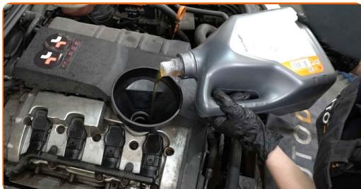
Výměna: motorového oleje a filtru - AUDI A3 Sportback (8VA, 8VF). AUTODOC doporučuje:
