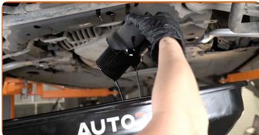
Výměna: motorového oleje a filtru - AUDI A3 Sportback (8VA, 8VF). Tip od odborníků z AUTODOC:
