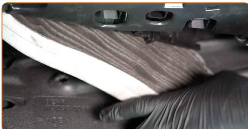
Výměna: kabinového filtru - AUDI A4 Allroad (8KH, B8). Doporučují odborníci z AUTODOC:
