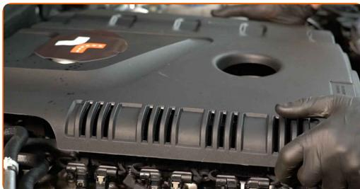
Výměna: zapalovacích svíček - AUDI A4 Allroad (8KH, B8). Tip:
