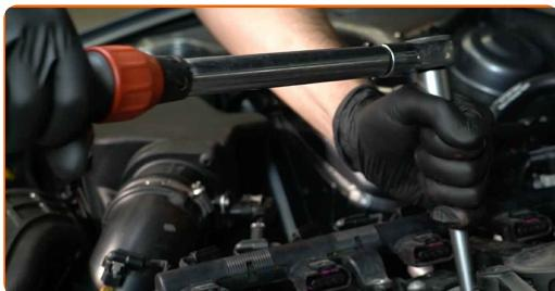
Výměna: zapalovacích svíček - AUDI A4 Allroad (8KH, B8). Doporučují odborníci z AUTODOC:
