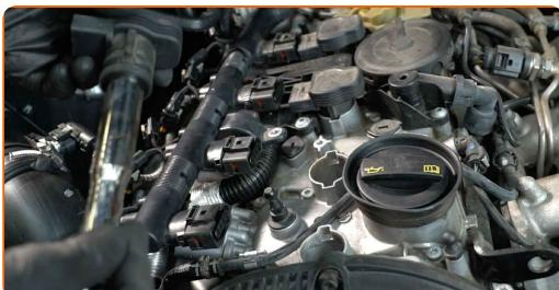
Výměna: zapalovacích svíček - AUDI A4 Allroad (8KH, B8). AUTODOC doporučuje:
