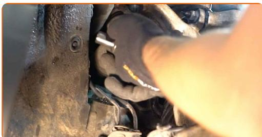
Výměna: kulového čepu řízení - AUDI A4 Sedan (8EC, B7). Profesionálové doporučují:
