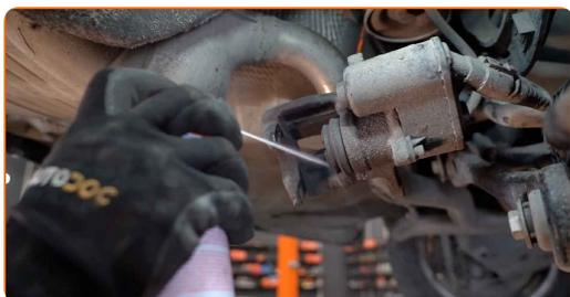
Výměna: brzdové destičky - AUDI A6 Allroad (4FH, C6). Tip:
