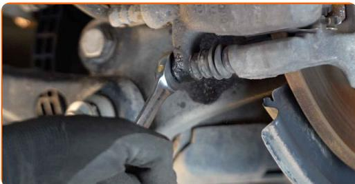
Výměna: brzdové destičky - AUDI A6 Allroad (4FH, C6). AUTODOC doporučuje:
