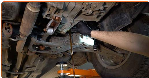
Výměna: olej do manuální převodovky - AUDI A6 Avant (4A5, C4). Doporučují odborníci z AUTODOC:
