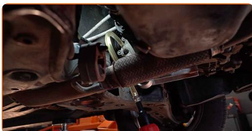
Výměna: olej do manuální převodovky - AUDI A6 Avant (4A5, C4). Tip od odborníků z AUTODOC:
