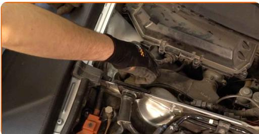
**71** Nainstalujte a zajistěte mřížku pro odvádění vody.
