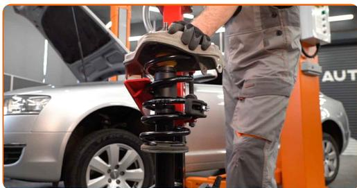
**42** Upevněte matici pístu vzpěry tlumiče. Použijte imbusový klíč č. H6. Použijte nástavec č.21. Použijte momentový klíč. Utáhněte ji točivým momentem 50 Nm.
