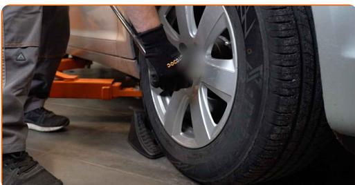
**9** Zvedněte přední část vozidla a zajistěte vozidlo na podpěrách.
