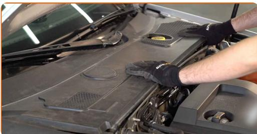
**72** Nainstalujte těsnění mřížky na odvádění vody.
