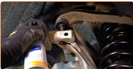
**57** Připojte vrchní rameno zavěšení kol k hlavě ložiska čepu řízení.
