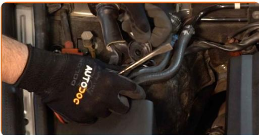
**6** Uvolněte vrchní upevňovací prvek ložiska vzpěry tlumiče. Použijte nástavec č.15. Použijte ráčnový klíč.
