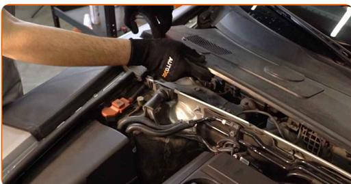
**5** Odstraňte kryt ložiska vzpěry tlumiče. Použijte páčidlo.
