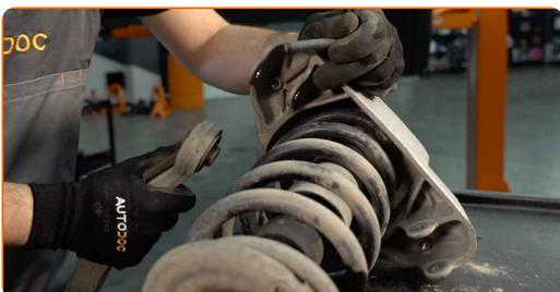
**29** Nastavte vzpěru tlumiče na zařízení pro stlačení pružiny.
