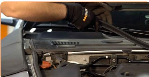
**4** Zvedněte a odstraňte mřížku pro odvádění vody.
