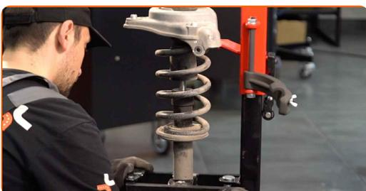
Výměna: pérovací jednotka - AUDI A6 Avant (4F5, C6). Tip:
