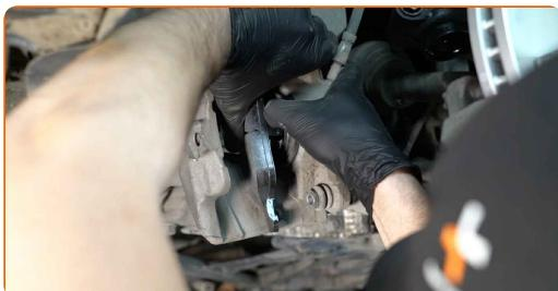
Výměna: brzdové destičky - AUDI A6 Avant (4G5, 4GD, C7). Profesionálové doporučují:
