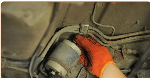
**7** Vyčistěte držák palivového filtru. Použijte drátěný kartáč. Použijte sprej WD-40.
