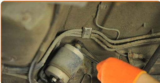
**6** Odpojte trubku z palivového filtru.
