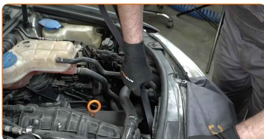
Výměna: drážkového řemene - AUDI A6 C6 Avant (4F5). Tip:
