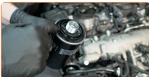
**15** Nainstalujte nový olejový filtr.
