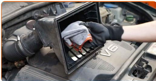
**13** Nainstalujte nový filtrační prvek do krytu filtru. Ujistěte se, že okraj filtru je těsně připevněn ke krytu.
