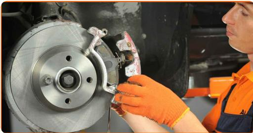
Výměna: brzdové destičky - AUDI Cabriolet B4 (8G7). AUTODOC doporučuje:
