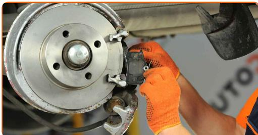
Výměna: brzdové destičky - AUDI Cabriolet B4 (8G7). Doporučují odborníci z AUTODOC:
