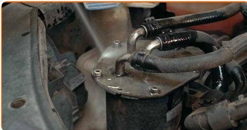
**4** Odšroubujte upevňovací prvky krytu uložení palivového filtru. Použijte hvězdicový Torx T15. Použijte ráčnový klíč.
