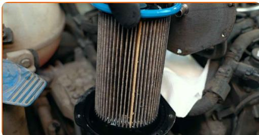
Výměna: palivového filtru - AUDI Q3 (8UB, 8UG). AUTODOC doporučuje:
