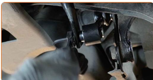
**13** Utáhněte upevňovací prvek spojující stabilizátor s ovládacím ramenem. Použijte nástavec č.14. Použijte momentový klíč. Utáhněte ji točivým momentem 45 Nm.
