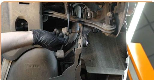
Výměna: tyčky stabilizátoru - AUDI TT Kupé (8J3). Tip od odborníků z AUTODOC:
