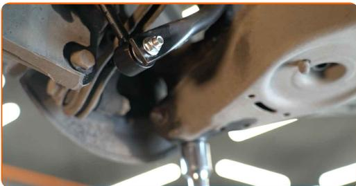
**15** Utáhněte upevnění spojující vzpěru stabilizátoru a stabilizátor. Použijte nástavec č.14. Použijte momentový klíč. Utáhněte ji točivým momentem 45 Nm.
