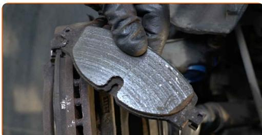
Výměna: brzdové destičky - AUDI TT Kupé (FV3, FVP). Tip od AUTODOC:
