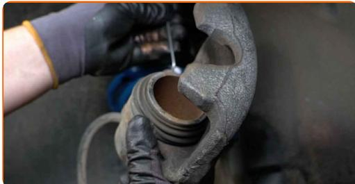
Výměna: brzdové destičky - AUDI TT Kupé (FV3, FVP). Tip od odborníků z AUTODOC:
