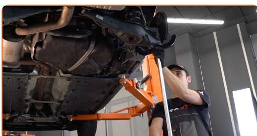
Výměna: uložení tlumiče - AUDI TT Roadster (8J9). Tip od odborníků z AUTODOC:
