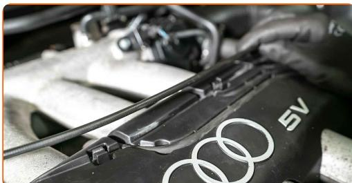
**4** Odstraňte konektory vodičů svíčky zapalování z otvorů pro svíčky zapalování.
