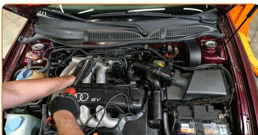
Výměna: zapalovacích svíček - AUDI TT Roadster (8N9). Profesionálové doporučují:
