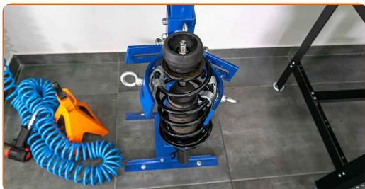
Výměna: uložení tlumiče - AUDI TT Roadster (8N9). Doporučují odborníci z AUTODOC:
