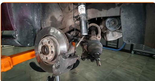
Výměna: uložení tlumiče - AUDI TT Roadster (8N9). Tip:
