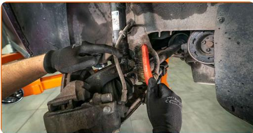
13 Odšroubujte upevňovací prvek spojující kulový čep a ovládací rameno odpružení. Použijte nástavec č.13.
