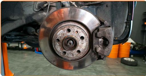
12 Vyčistěte upevňovací prvky spojující vzpěru tlumiče a hlavu ložiska čepu kola. Vyčistěte upevňovací prvky spojující kulový čep a ovládací rameno odpružení. Použijte drátěný kartáč. Použijte sprej WD-40.
