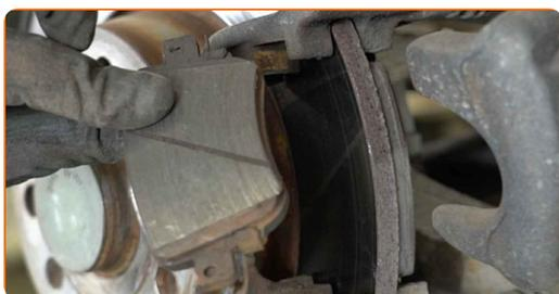
Výměna: brzdové destičky - AUDI TT Roadster (FV9, FVR). Tip od AUTODOC:
