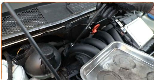
Výměna: motorového oleje a filtru - Mercedes W245. Profesionálové doporučují:
