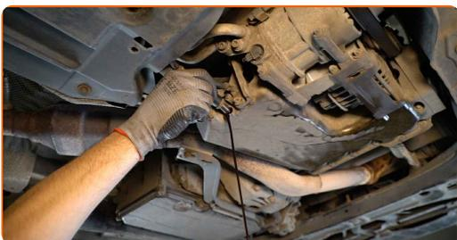
Výměna: motorového oleje a filtru - Mercedes W245. Tip od odborníků z AUTODOC:
