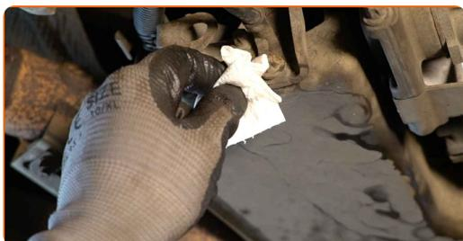
**20** Zašroubujte novou zátku výpustného otvoru a utáhněte ji. Použijte nástavec č.13. Použijte momentový klíč. Utáhněte ji točivým momentem 28 Nm.
