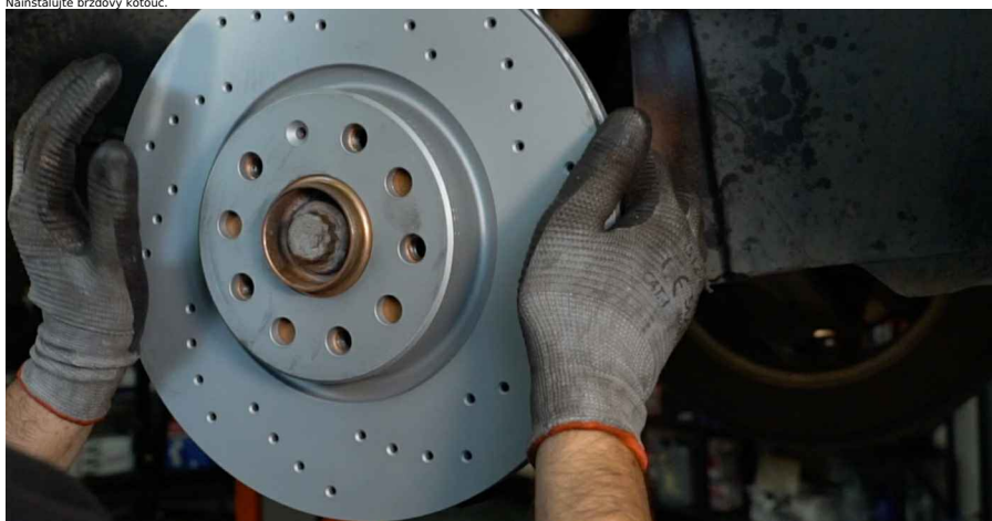
21 Upevněte upevnění brzdového kotouče. Použijte hvězdicový Torx T 30. Použijte momentový klíč. Utáhněte jej točivým momentem 4 Nm.
