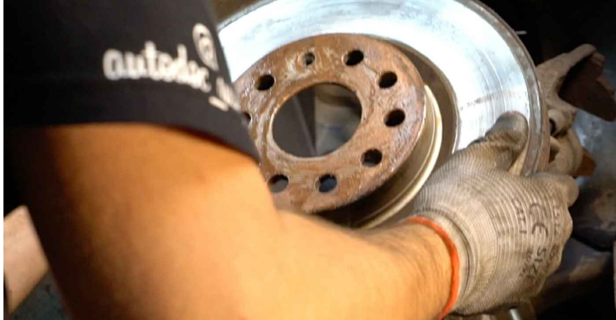
19 Vyčistěte náboj. Použijte drátěný kartáč. Nařete kontaktní povrch. Použijte měděné mazivo.
