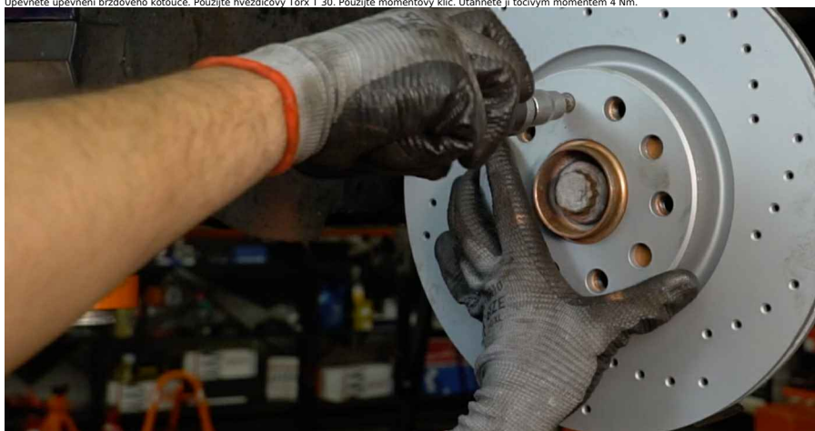
21 Upevněte upevnění brzdového kotouče. Použijte hvězdicový Torx T 30. Použijte momentový klíč. Utáhněte jej točivým momentem 4 Nm.
