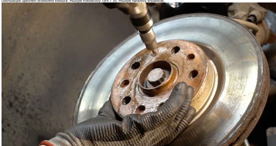
17 Odšroubujte upevnění brzdového kotouče. Použijte hvězdicový Torx T 30. Použijte nárazový šroubovák.
