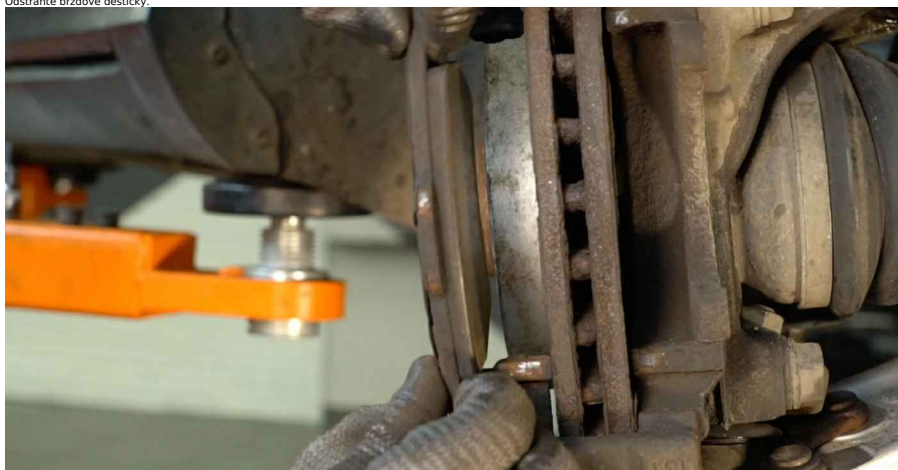
13 Vyčistěte upevňovací prvky držáku brzdového třmenu. Použijte drátěný kartáč. Použijte sprej WD-40.
