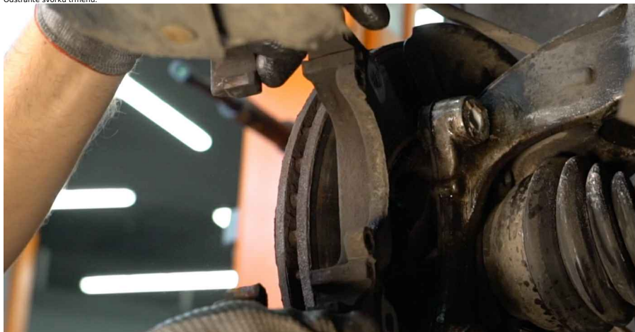
16 Vyčistěte upevňovací prvky brzdového kotouče. Použijte drátěný kartáč. Použijte sprej WD-40.
