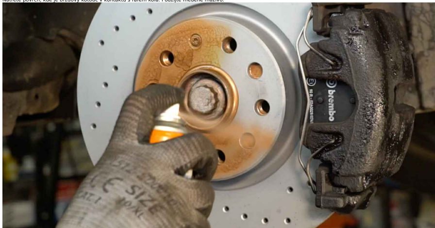
32 Vyčistěte povrch brzdového kotouče. Použijte čistič brzd.
