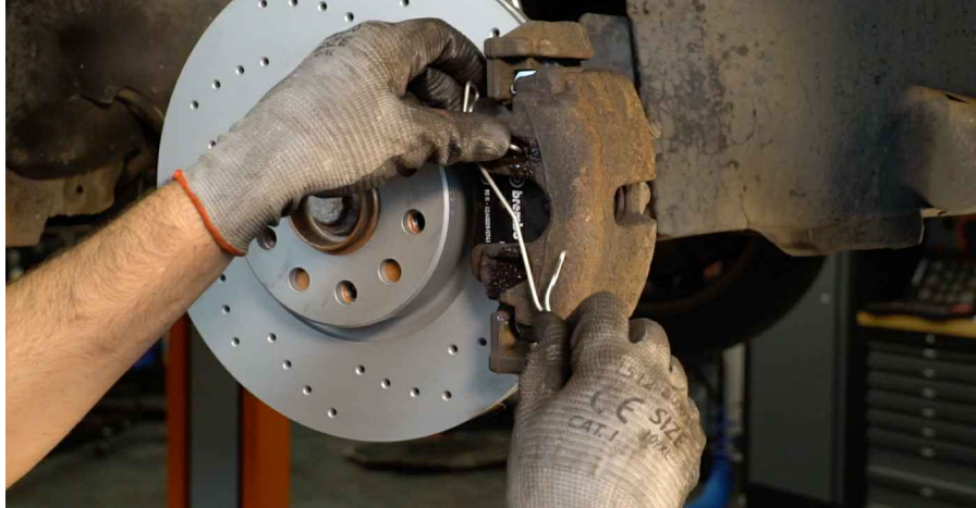
31 Natřete povrch, kde je brzdový kotouč v kontaktu s ráfem kola. Použijte měděné mazivo.
