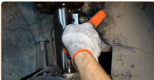
7 Odšroubujte upevnění spojující vzpěru stabilizátoru a vzpěru tlumiče. Použijte nástavec č.18. Použijte ráčnový klíč.
