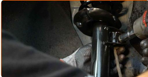
8 Odšroubujte upevnění spojující vzpěru stabilizátoru a stabilizátor. Použijte kombinační klíč č.18. Použijte imbusový klíč č. H5. Použijte ráčnový klíč.
