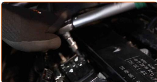
22 Konektor cívky zapalování ošetřete pomocí spreje na elektroniku.
