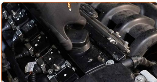
25 Odstraňte uzávěr olejového systému.
