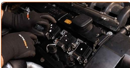
Výměna: zapalovacích svíček - BMW 1 Hatchback (E87). Doporučují odborníci z AUTODOC:
