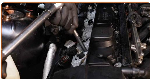
Výměna: zapalovacích svíček - BMW 1 Hatchback (E87). AUTODOC doporučuje:
